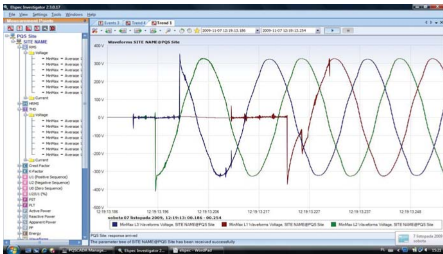
Rys. 3. Rozciągnięcie w czasie operacji załączenia napięcia wyłącznikiem nadprądowym o godzinie 12: 19: 13
