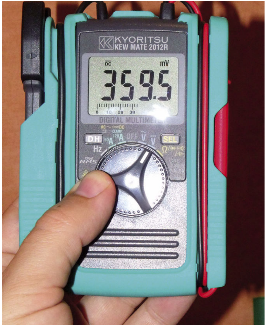
Fotografia 2. Multimetr można obsługiwać jedną ręką. Wszystkie przełączniki są dostępne w zasięgu kciuka ręki trzymającej przyrząd
