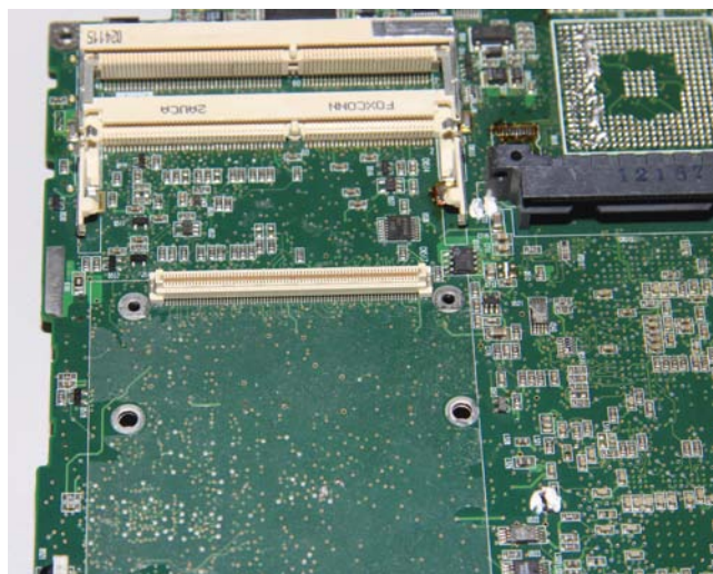
Fot. 5. Demontaż gniazda SMD z elementami plastikowymi
