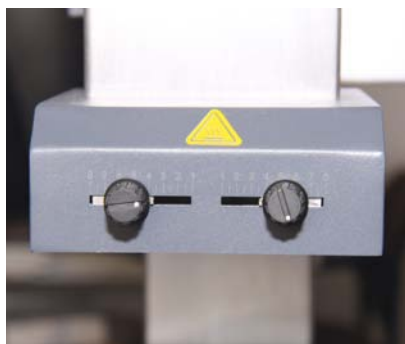
Fot. 4. Mechaniczna przesłona wiązki podczerwieni górnego grzejnika
