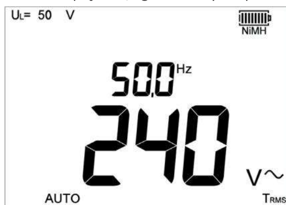
Rys. 2 Miernik wskazuje, że obwód znajduje się pod napięciem.
