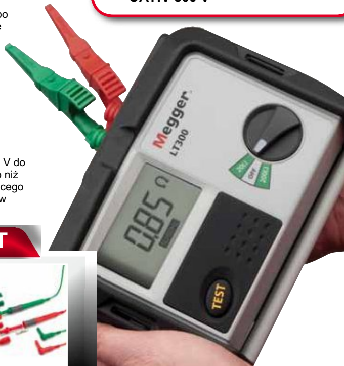
1001-977 Zestaw przewodów pomiarowych z bezpiecznikami 10 A
