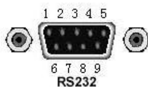
Rysunek 5-1 Złącze interfejsu RS232 na tylnym panelu urządzenia
