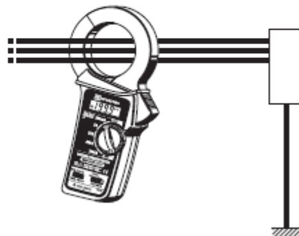
Obwód trójfazowy 3-przewodowy (w obwodzie 4-przewodowym z przewodem neutralnym cęgi założyć na wszystkie 4 przewody)
