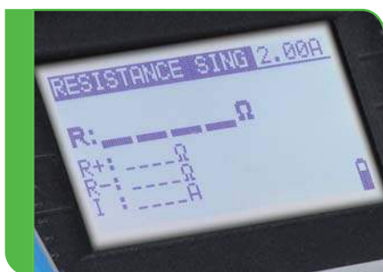
Duży wyświetlacz analogowy / cyfrowy z podświetleniem
