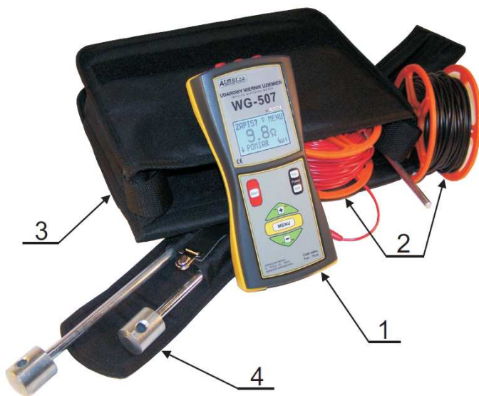
Rys. 2. Widok poszczególnych elementów wyposażenia miernika WG-507: 1- miernik, 2 - szpule z przewodami, 3 – torba, 4 - pokrowiec z sondami
