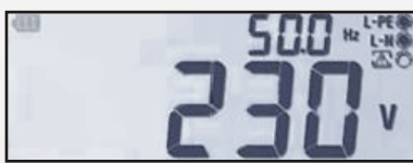
Pomiar napięcia i Hz
